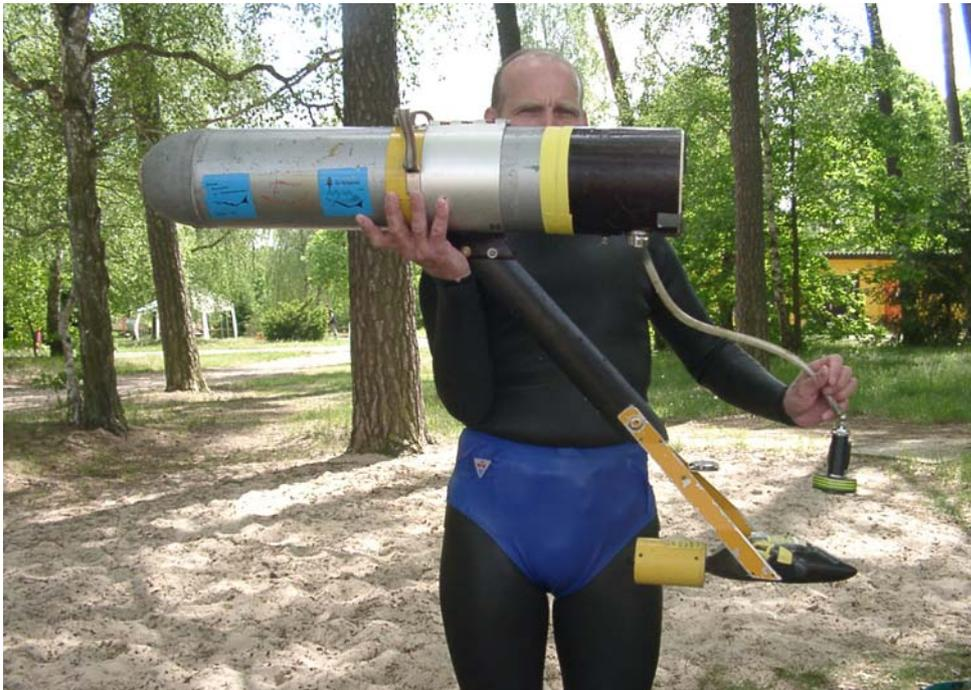
Die Ausrüstung eines Orientierungstauchers : ein DTG hier mit 8 Liter Inhalt und ein dazugehöriger Lungenautomat, dann das Verbindungsstück und anschließend Kompass, Strecken- und Tiefenmesser auf einer Konsole vereinigt (hier auch mit angebrachter Uhr in Höhe Obergrenze Badehose).
