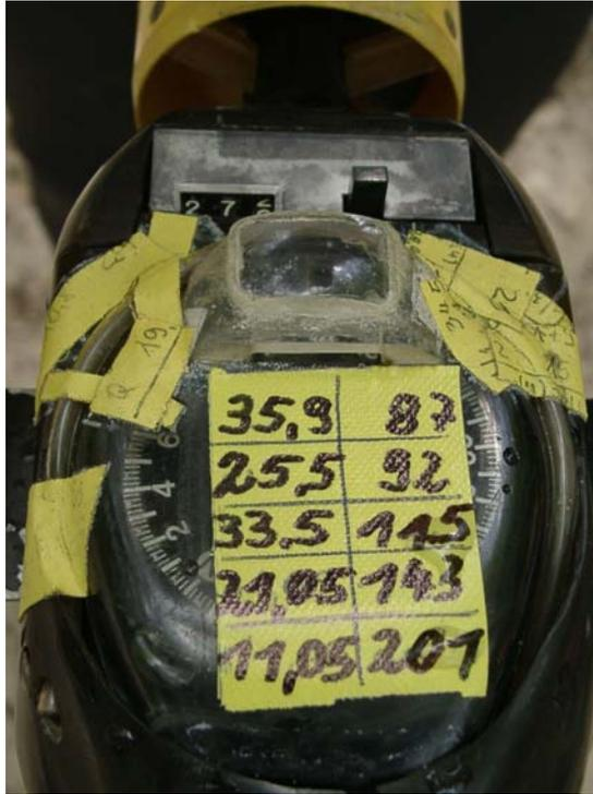
Das „Herz“ der Ausrüstung : Kompass, Tiefen-, und Meterzähler. Der Kompass ist durch das Vergrößerungsglas in der Mitte zu erkennen, die Tiefe liest man an dem abgeklebten Teil des Glasröhrchens links vom Vergrößerungsglas ab und die abgeschwommene Strecke zeigt der Streckenzähler links oberhalb vom Vergrößerungsglas. Alle 3 Instrumente befinden sich auf einer Ebene damit sie mit einem Blick schnell erfasst werden können.
